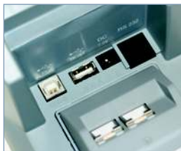
Vielfältige Anschlussmöglichkeiten u.a. LAN-Switch, USB Host, z.B. für Komfortsignaturkomponenten
